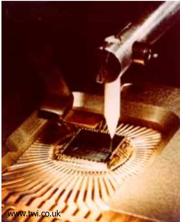
Bondkopf mit Chip auf Substrat
